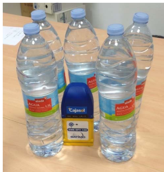
FIGURA 6. Exposímetro midiendo las ondas de RF que inciden sobre él estando rodeado por botellas de agua. Vista frontal, se ha desplazado una de las botellas para verlo mejor.
