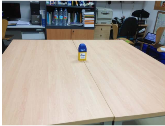
FIGURA 3. Exposímetro midiendo las ondas de RF que inciden sobre él.
