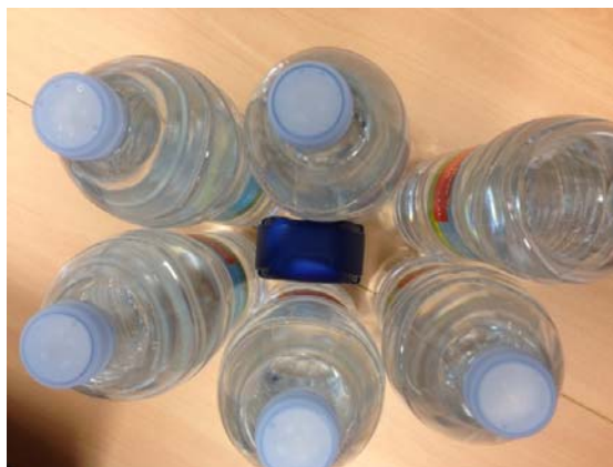
FIGURA 5. Exposímetro midiendo las ondas de RF que inciden sobre él estando rodeado por botellas de agua. Vista cenital.
