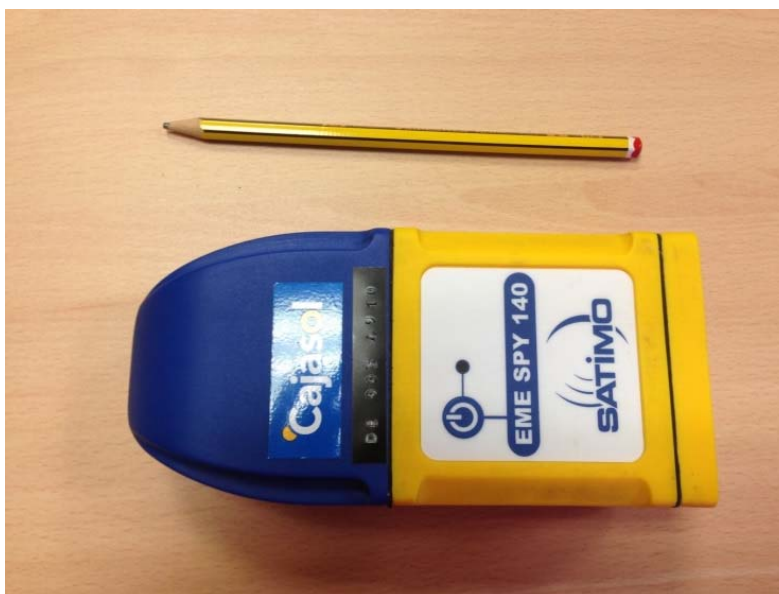
FIGURA 2. Exposímetro Satimo EME Spy 140 utilizado en nuestro experimento.
