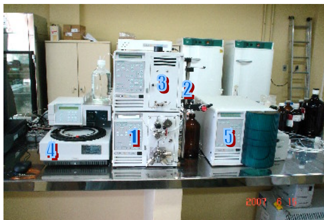
Figura 9 – Equipamento para HPLC da Varian, série Pro Star (em primeiro plano), composto de (1) sistema de bombeamento, (2) coluna, (3) detector UV, (4) injetor automático de amostra e (5) detector fluorimétrico
